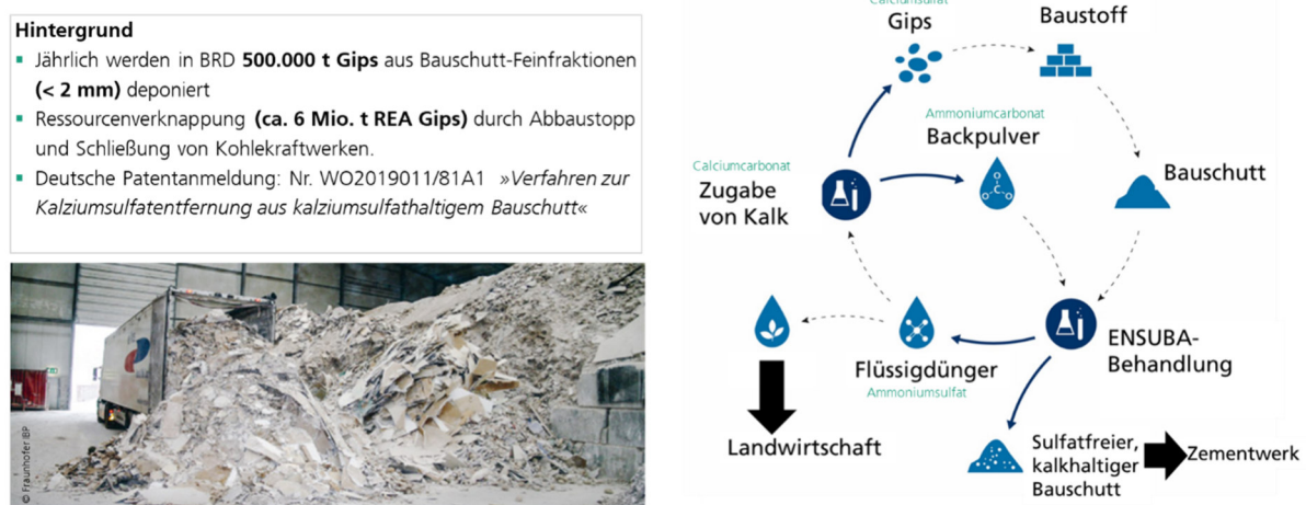
Bild 32: Projekt ENSUBA: Entsulfatisierung von Bauabfall.
