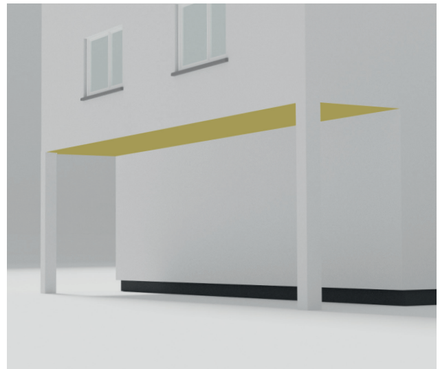
Abb. 4: Aufständering mit horizontaler Dämmung der Untersicht
