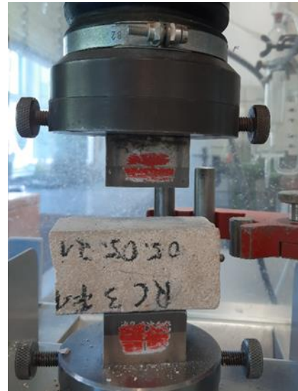
Abbildung 4: Biegezugfestigkeit (BZF) und Druckfestigkeit (DF), RTA mit Anreger, 28 Tage Lagerung
