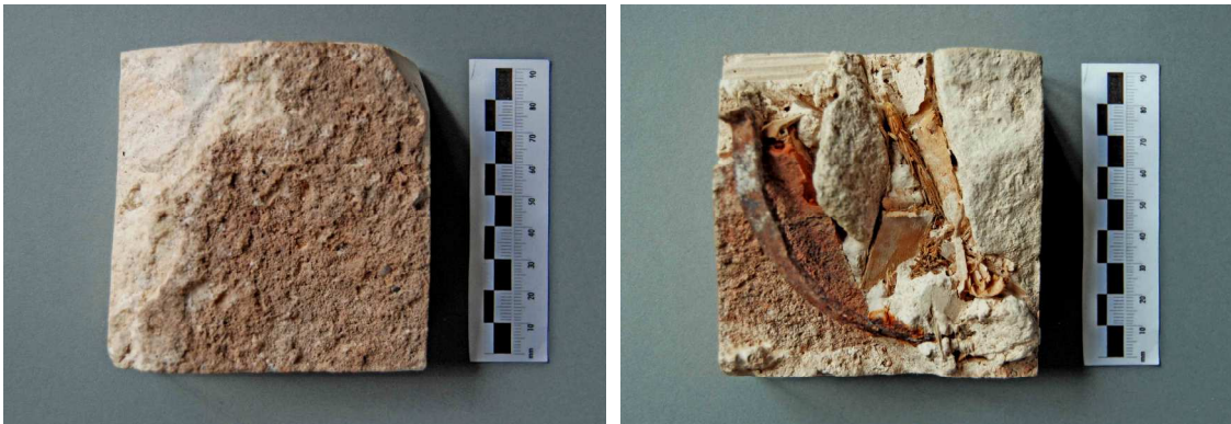
Abb. 9 / 10: Die Unterseiten der Proben der Gipsestriche von Burg Hanstein (links) sowie die der Probe aus Paulinzella (rechts) zeigen hingegen nur Abdrücke von Sanden und feinen Gesteinskörnungen, die vermutlich keine kapillarbrechende Wirkung erzielten. In der Probe von Paulinzella sind sogar noch ein Eisennagel und andere Fremdmaterialien (z.B. Holz) zu erkennen. Die Vorbereitung des Untergrundes wurde somit nicht immer bis ins Detail ausgeführt.
