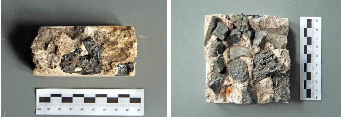
Abb. 7 / 8: Die Unterseiten der Gipsestriche in Stolberg (links) und in Ilsenburg (rechts) zeigen grobe magmatische Gesteinskörnungen, die in den Mörtel eingebettet sind.
