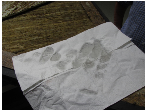
Durchfeuchtete Bereiche einer Paneel-Konstruktion
