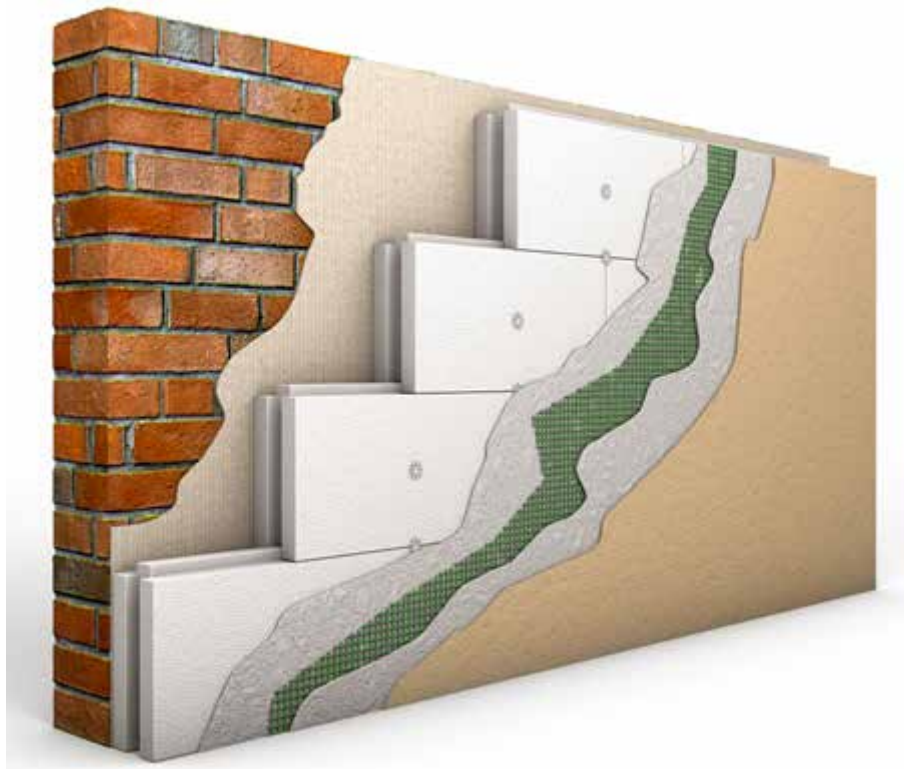
Abbildung 11: Wärmedämm-Verbundsysteme dienen der Dämmung von Außenwänden im Neubau und bei Bestandsgebäuden: Bildquelle: ©kiono - stock.adobe.com
