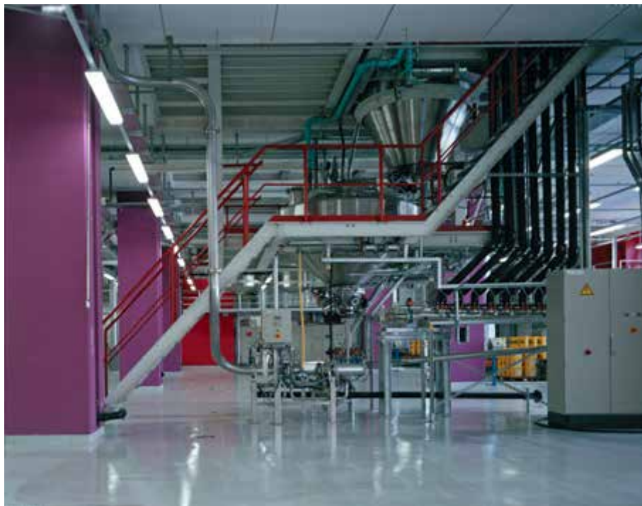
Abbildung 19: Nassproduktionswerk für organisch gebundene Mörtel; Bildquelle: Sto SE
