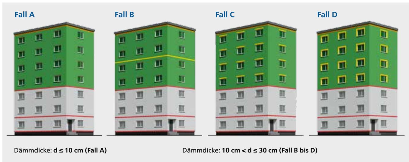
Abbildung 41: Konstruktive Brandschutzmaßnahmen an höheren Gebäuden (beispielhaft)
