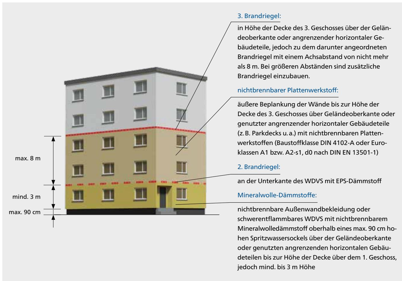
Abbildung 32: Anordnung der Brandriegel in der Schutzzone Sockelbrand, Fall B2, der Übergang vom untersten Geschoss zum WDVS mit EPS-Dämmung kann inhaltlich so wie in Fall B1 ausgeführt werden
