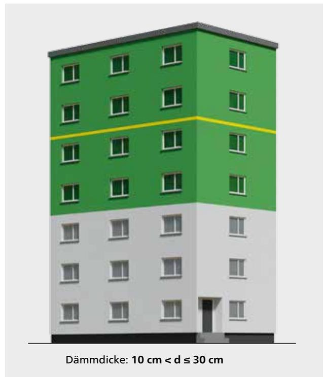
Abbildung 14: Umlaufender Brandriegel am Gebäude
