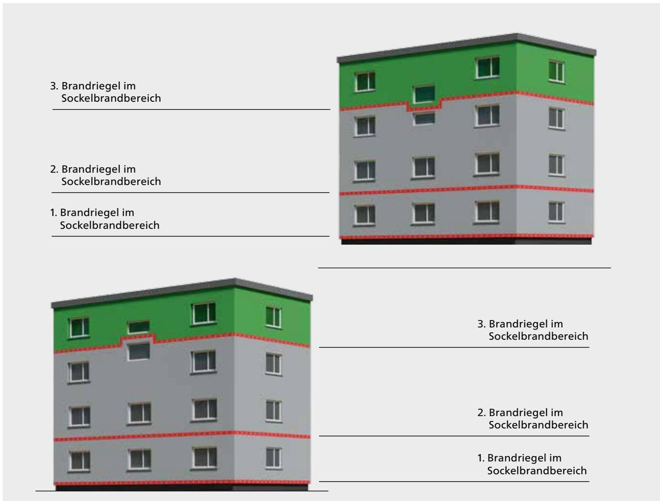
Abbildung 48: Prinzipdarstellung der Ab- bzw. Auftreppung – Im Falle des 1. Brandriegels (Sockelriegel) kann, bedingt durch seine besondere Lage am Gebäude, anstelle einer Auftreppung auch die im Abschnitt 4.3.3.2 (Abbildung 30) beschriebene Ausführung gewählt werden
