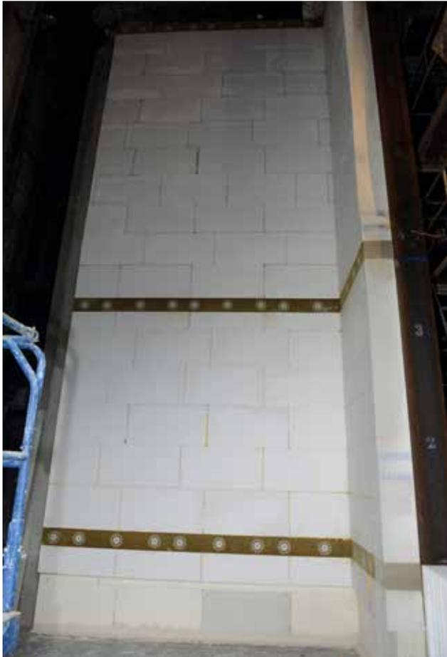
Bild 21: Versuchsaufbau Dämmbereich mit Brandriegeln
