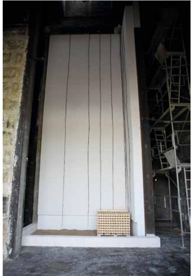
Bild 22: Versuchsaufbau mit WDVS verputzt
