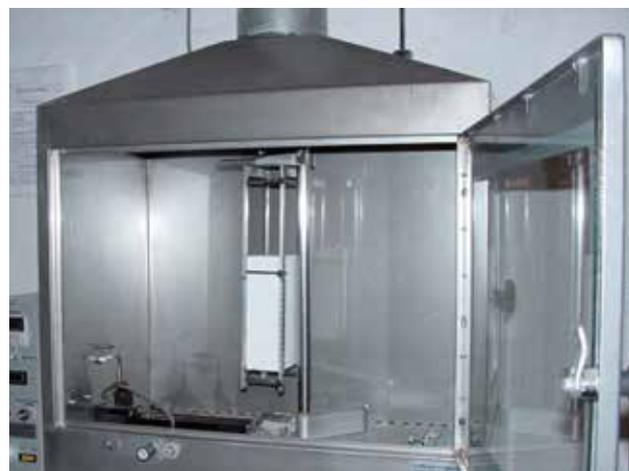
Bild 7: Brennkasten mit eingebauter Probe
