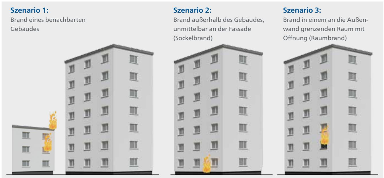
Abbildung 1: Brandszenarien an der Gebäudeaußenwand
