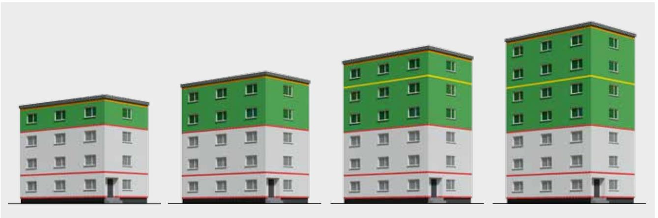
Abbildung 47: Beispiele für die Anordnung von Brandriegeln bei Gebäuden der GK 4 und 5 mit angrenzenden brennbaren Bauprodukten am Dach
