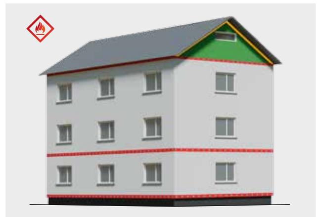
Abbildung 38: 3. Brandriegel in Doppelfunktion auch als Abschlussriegel
