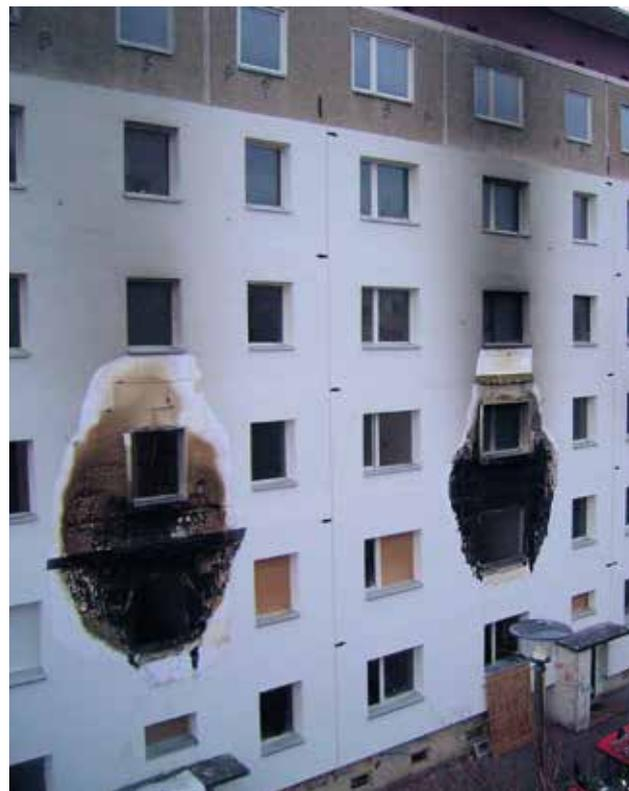
Bild 16: Versuchsgebäude mit EPS-WDVS nach den Brandversuchen, Putz teilweise entfernt – Brandriegel verhindern geschossübergreifende Brandweiterleitung
