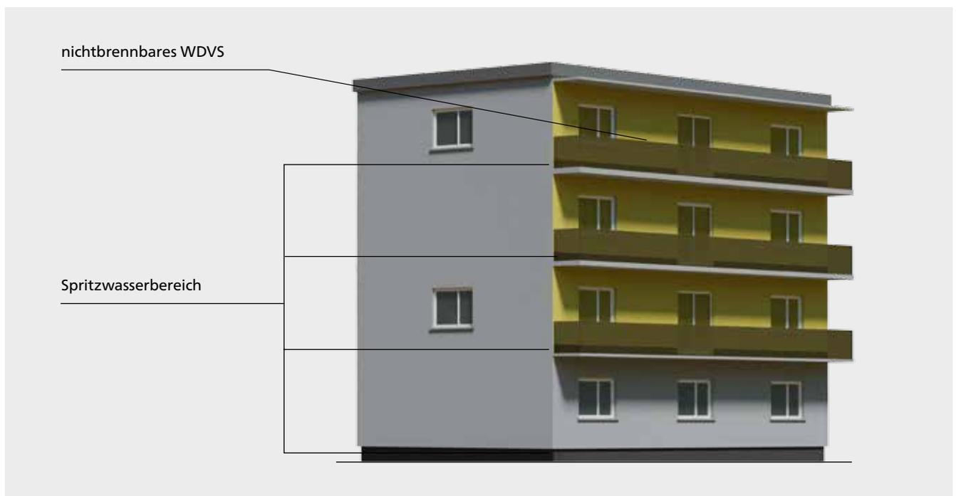
Abbildung 6: Mögliche Ausführung eines WDVS an „offenen“ Fluren, die ausgewiesene Fluchtwege sind
