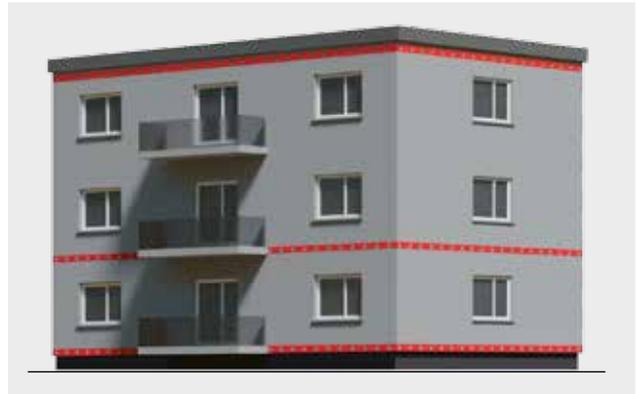
Abbildung 53: Beispielhafte Ausbildung eines Brandriegels unter Einbeziehung einer Balkonkragplatte
