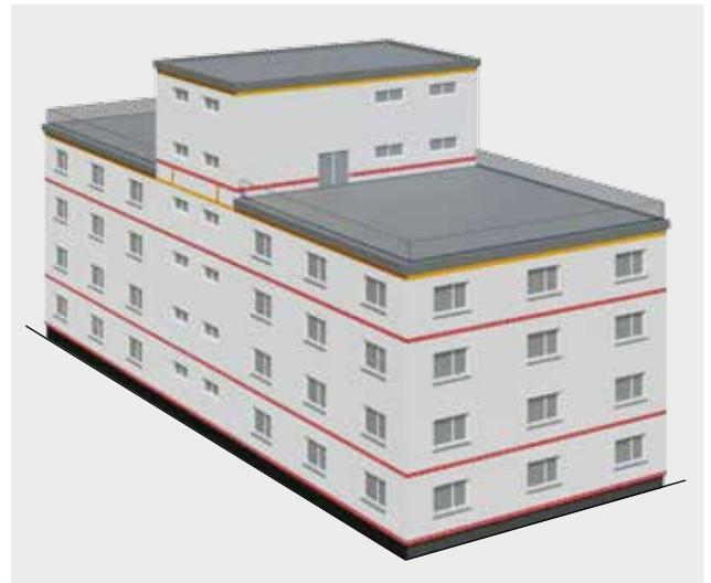
Abbildung 43: Anordnung des Sockelriegels bei angrenzendem Warmdach
