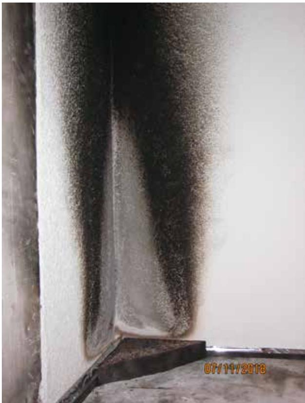
Bild 9: SBI-Prüfkörper (WDVS) nach der Brandprüfung
