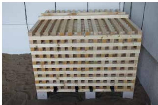
Bild 19: Brandlast (Holzkrippe) dem Probenkörper
