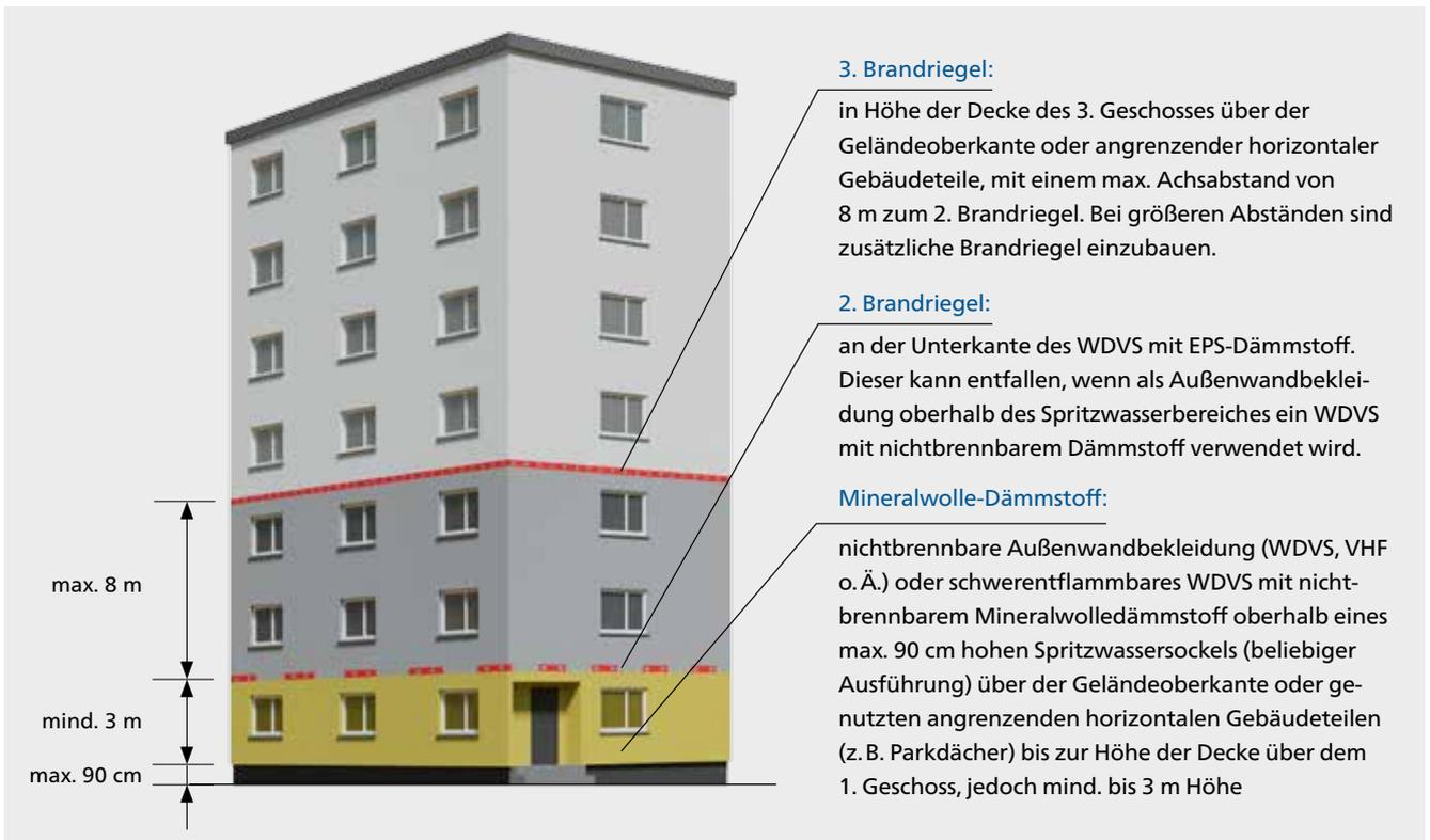
Abbildung 30: Anordnung der Brandriegel in der Schutzzone Sockelbrand, Fall B1
