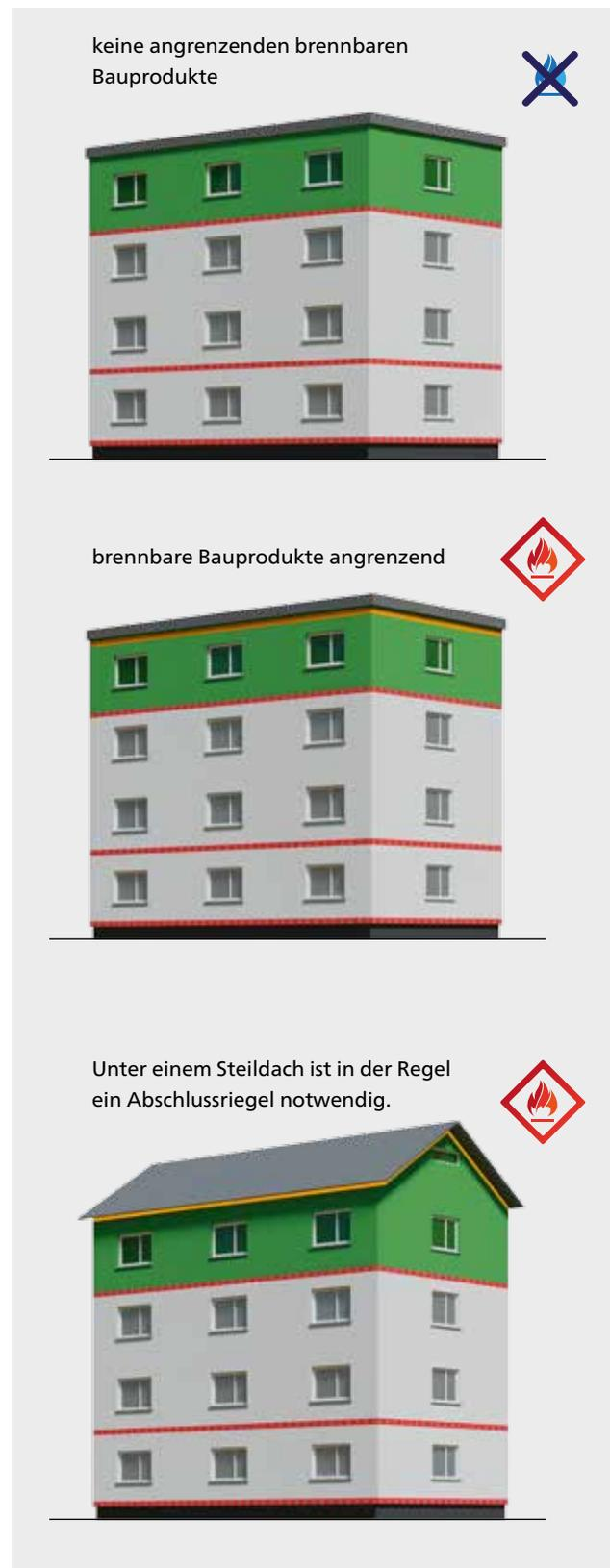
Abbildung 35: Ausführung von „Abschlussriegeln“ unterhalb von Dächern
