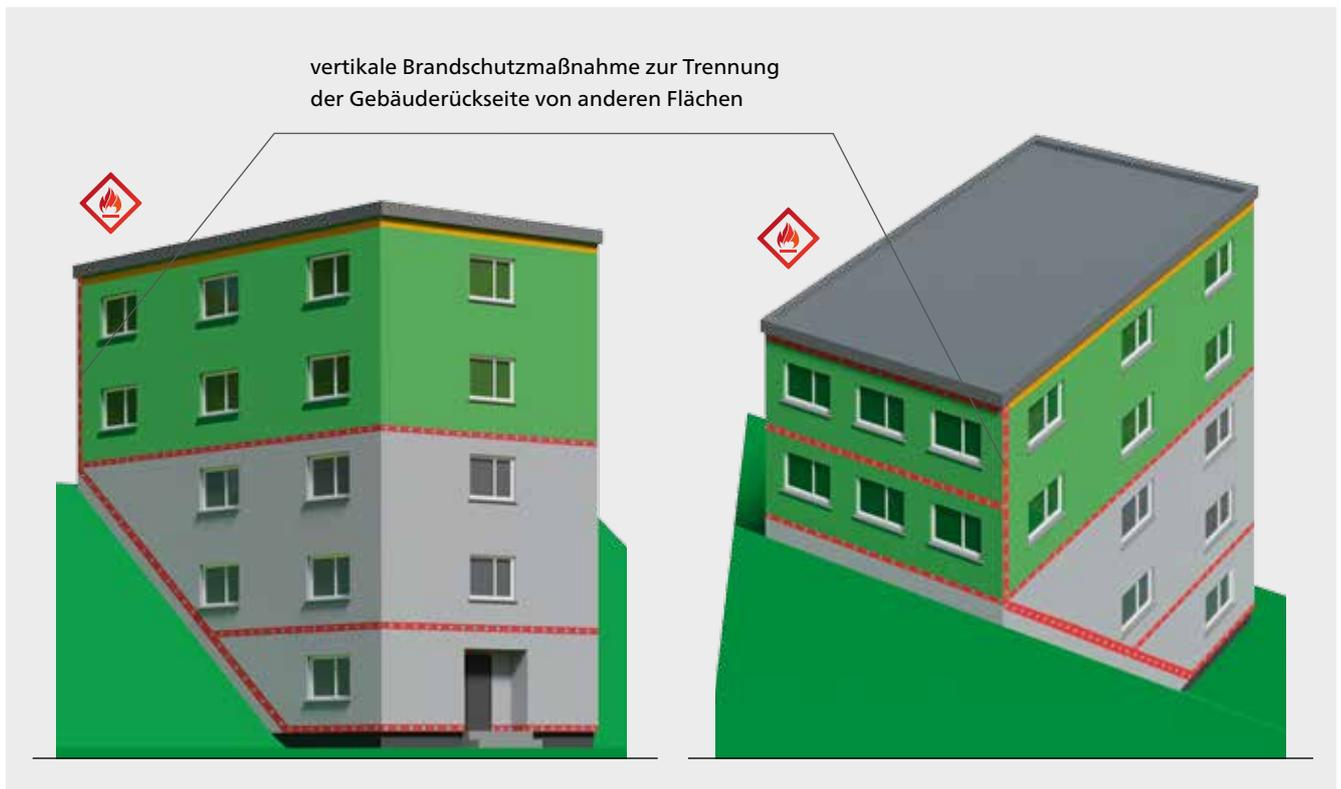
Abbildung 51: Beispielhafte Anwendung von Brandriegeln bei hanglagigen Gebäuden
