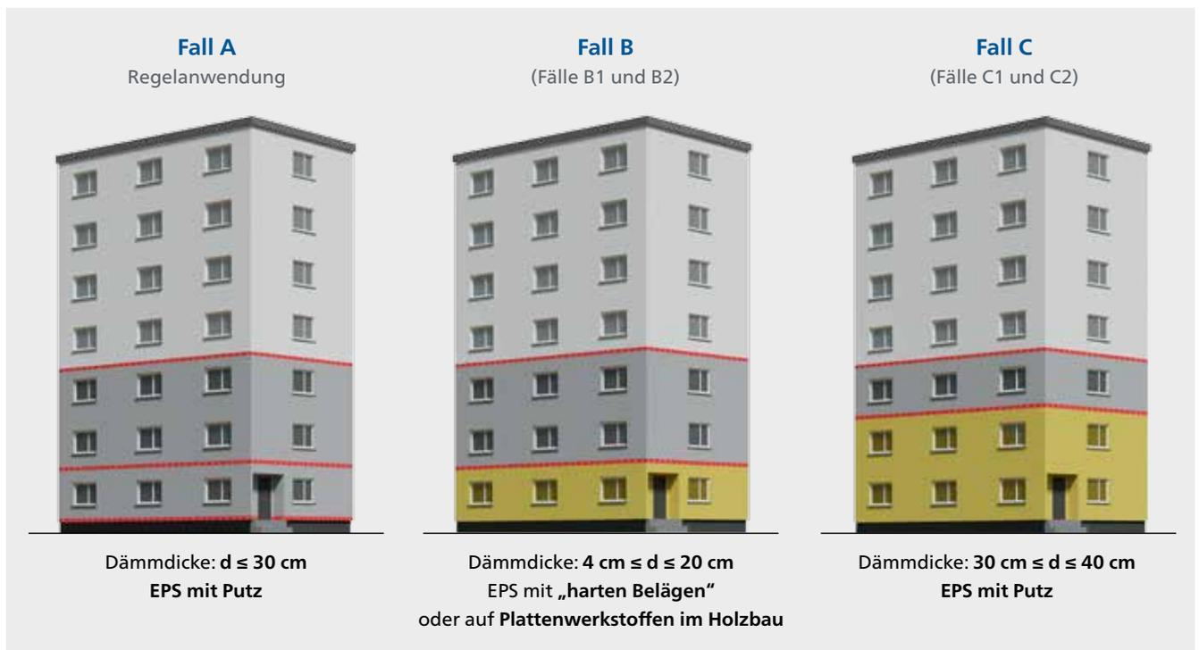
Abbildung 25: Konstruktive Schutzmaßnahmen für die Schutzzone Sockelbrand im Überblick
