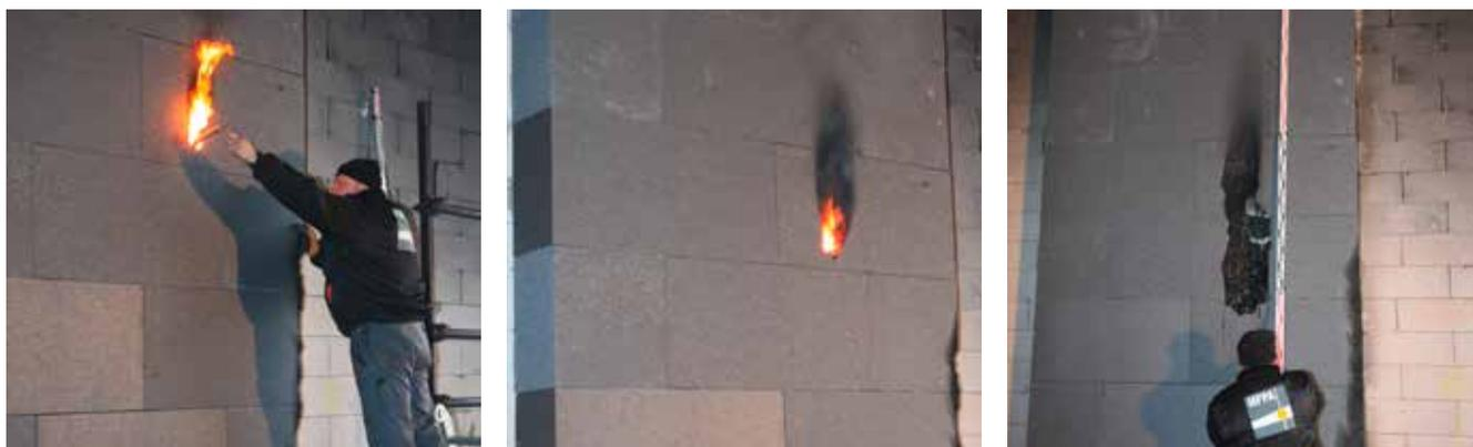
Bild 34: „Bengalo“ (Brennzeit 4 Minuten) brennend in EPS-Dämmung gesteckt
