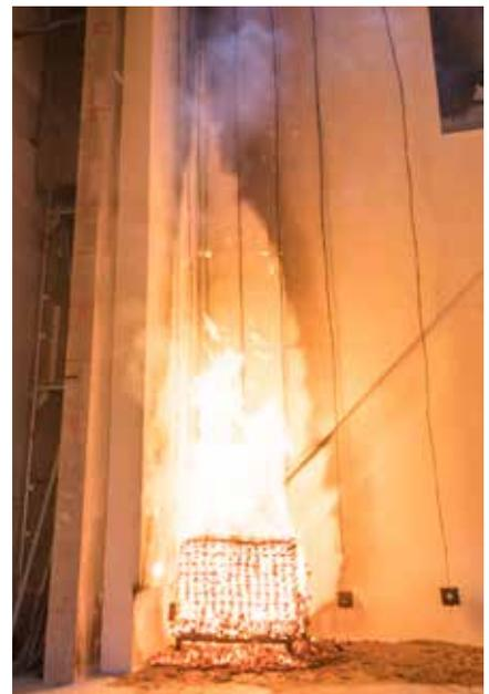
Bild 28: Brandentwicklung während des Versuchs
