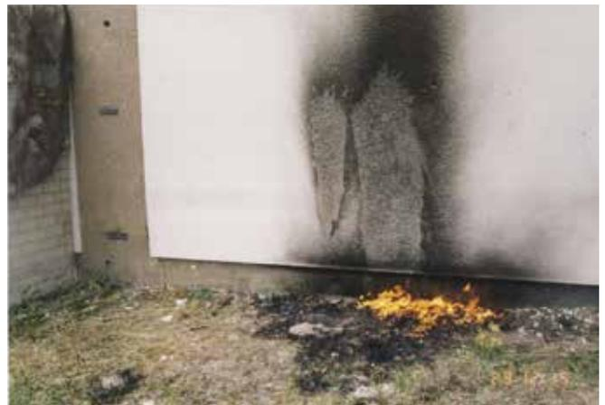
Bild 36: Brandbeschleuniger (2 l Benzin) flächig auf EPS-WDVS geschüttet
