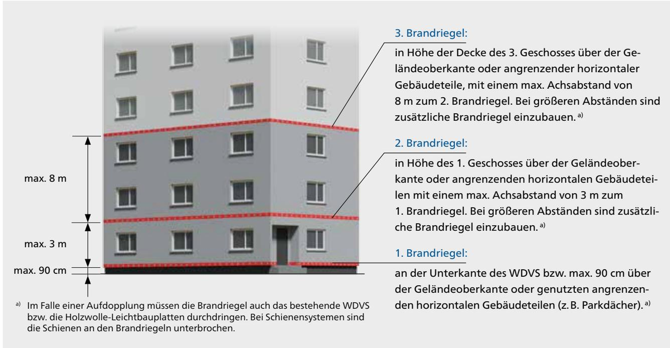
Abbildung 26: Anordnung der Brandriegel in der Schutzzone Sockelbrand, Fall A
