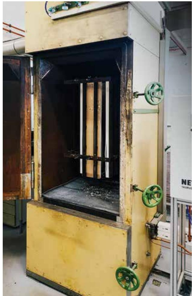
Bild 8: Brandschacht mit eingebautem Probenkorb
