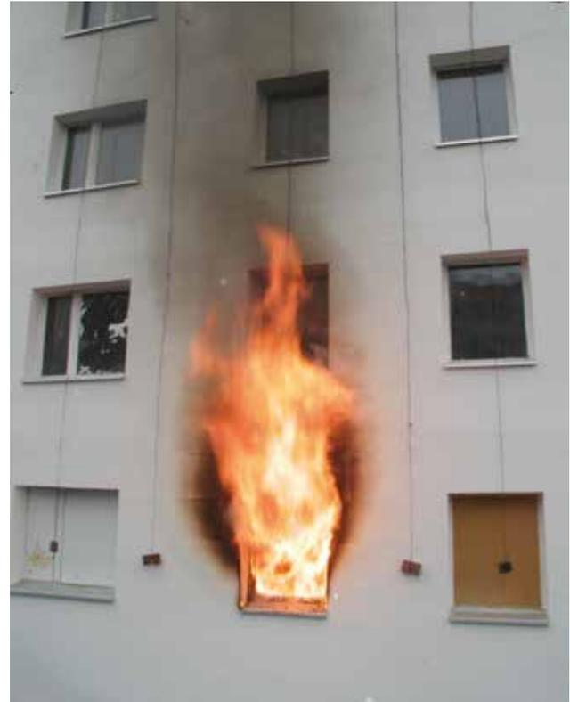
Bild 14: Brandentwicklung vor der Fassade bei einem Raumbrand
