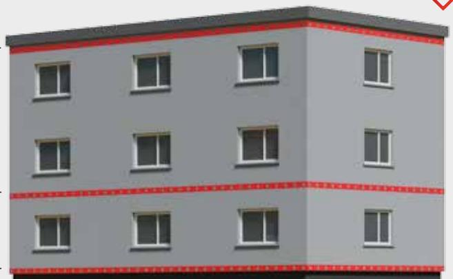
Abbildung 45: Beispielhafte Ausführung der Brandschutzmaßnahmen bei einem brennbaren Flachdach
