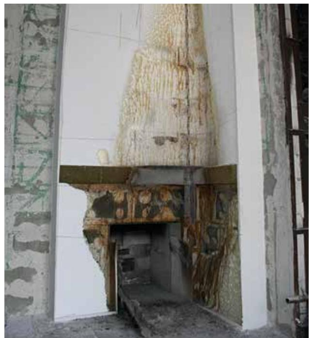
Bild 11: Dämmung nach der Brandprüfung (Putz entfernt)
